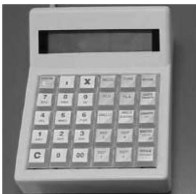
Per questa particolare configurazione è prevista la possibilità di connettere all'apparecchio un tipo di tastiera ridotta (30 tasti) completa di display operatorio con le medesime caratteristiche del modello 65 tasti. In questa tastiera le funzioni sono ridotte ai comandi essenziali ed hanno caratteristiche medesime a quelle estese già illustrate nel Capitolo precedente.
